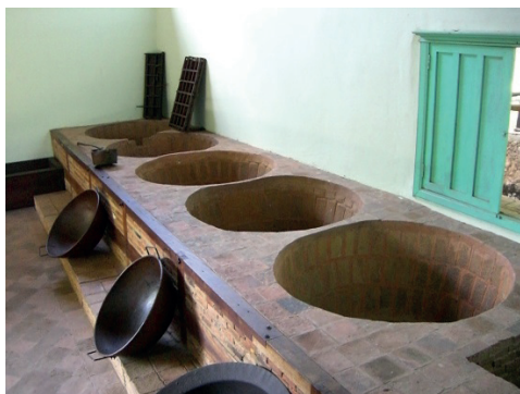
Figura 2. Tren de pailas y moldes para la panela. Trapiche Los Clavo. Boconó, estado Trujillo Foto: L. Molina.
